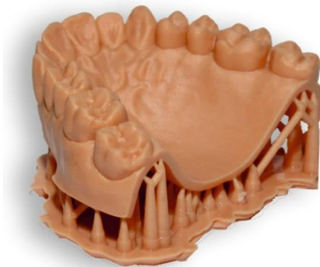
Figure 13 : a et b : impression de moulage SLA
