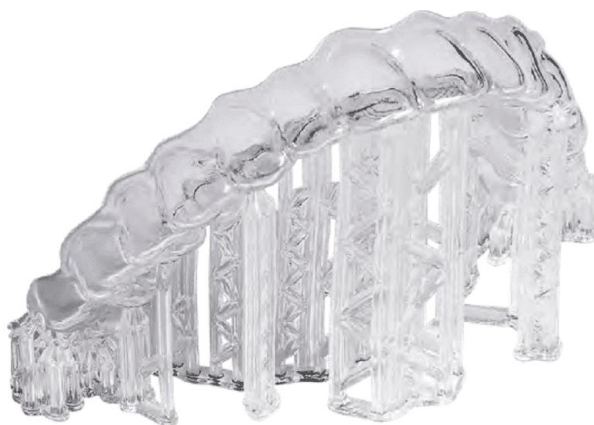
Figure 16 : impression directe de l'aligneur avec supports avec la résine GRAHPY (Forestadent)
