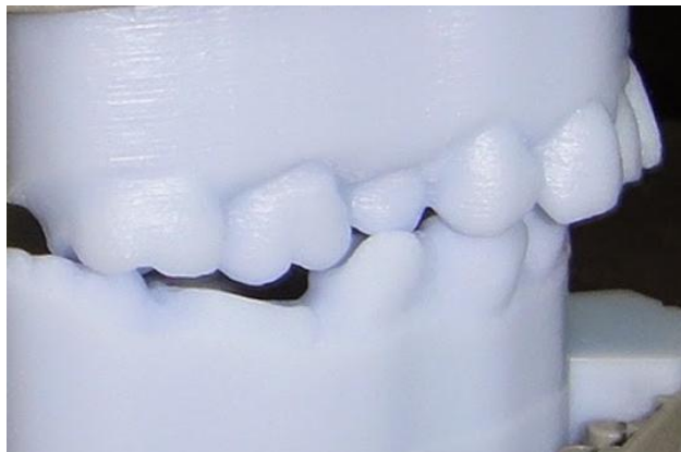
Figure 13 : a et b : impression de moulage SLA
