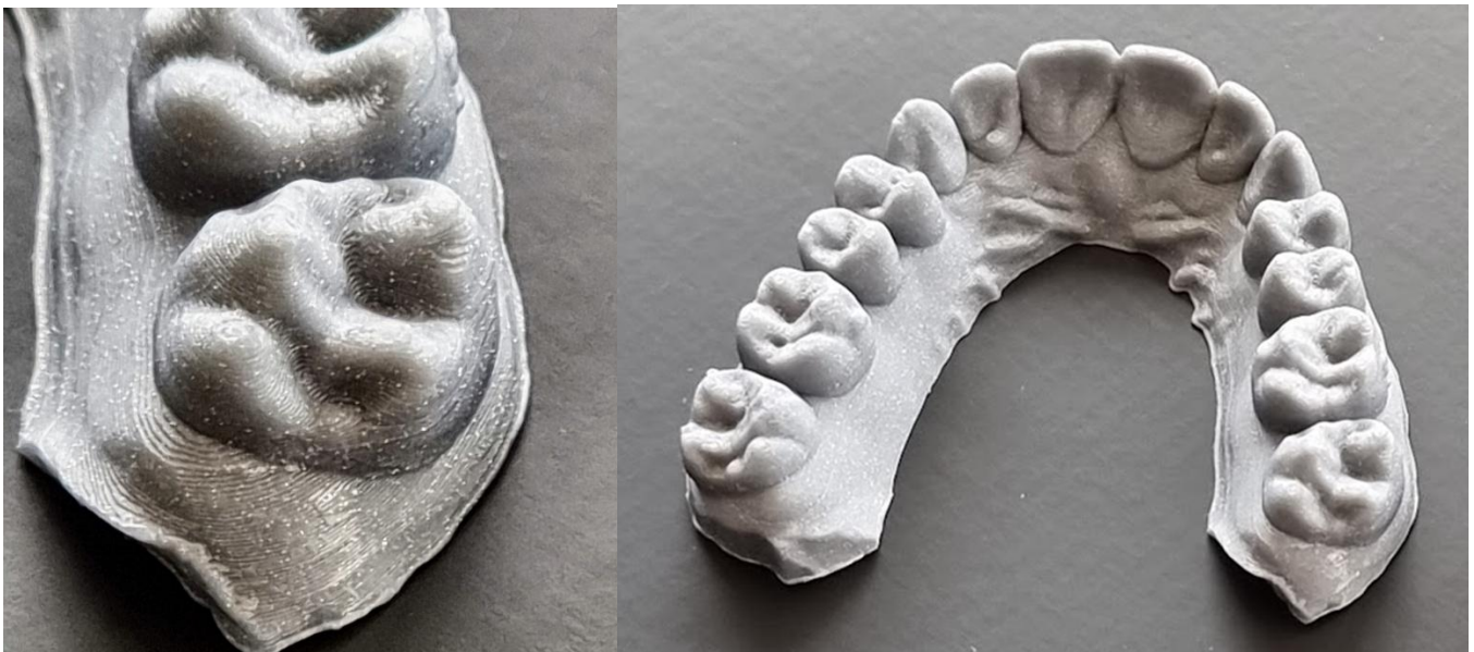
Figure 9 : Stries visible sur un modèle FDM (layer à 150µm)
