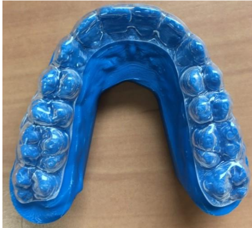
Figure 10 : Aligneurs thermoformés sur moulage FDM
