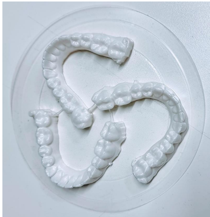
• Figure 15 : Thermoformage d'aligneurs (plusieurs sur une plaque de 125mm de diamètre)
