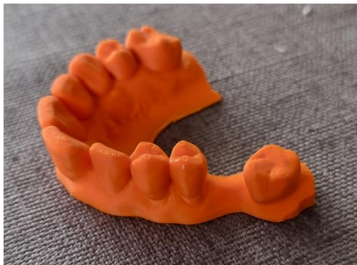
Figure 7 : Impression FDM d'un moulage
